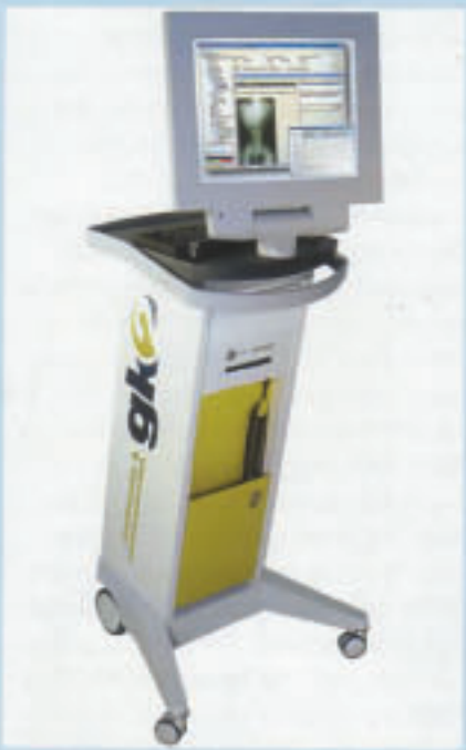
Der Kommunikationsterminal erfüllt laut Herstellerangaben die sicherheitstechnischen Anforderungen und die EMV-Anforderungen wie ein Medizingerät sowie die Anforderungen der DIN EN 60601-1.
